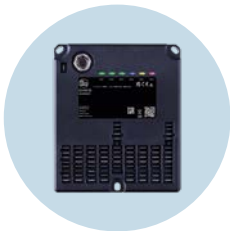
ecomatBasic 用于移动机械的可编程 控制器
