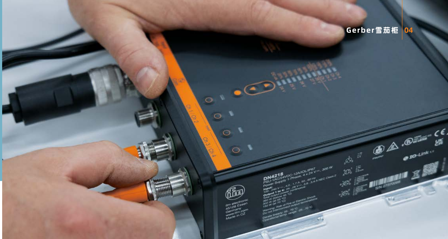
所有部件均使用标准化的M12连接器连接。
