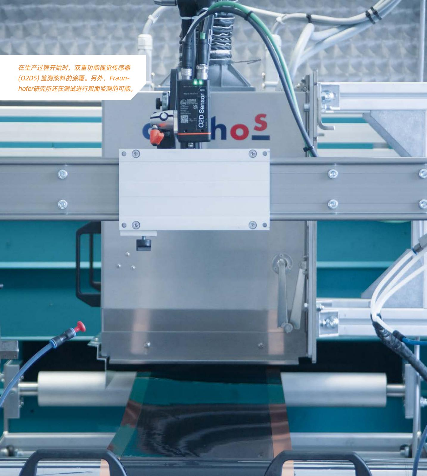
在生产过程开始时，双重功能视觉传感器 (O2D5) 监测浆料的涂覆。另外，Fraunhofer研究所还在测试进行双面监测的可能。
