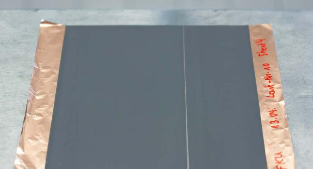
浆料涂层中的空隙会产生次品，因此必须对其加以识别。ifm的双重功能视觉传感器可以指示这种缺陷，从而有助于最大限度地降低次品率。
