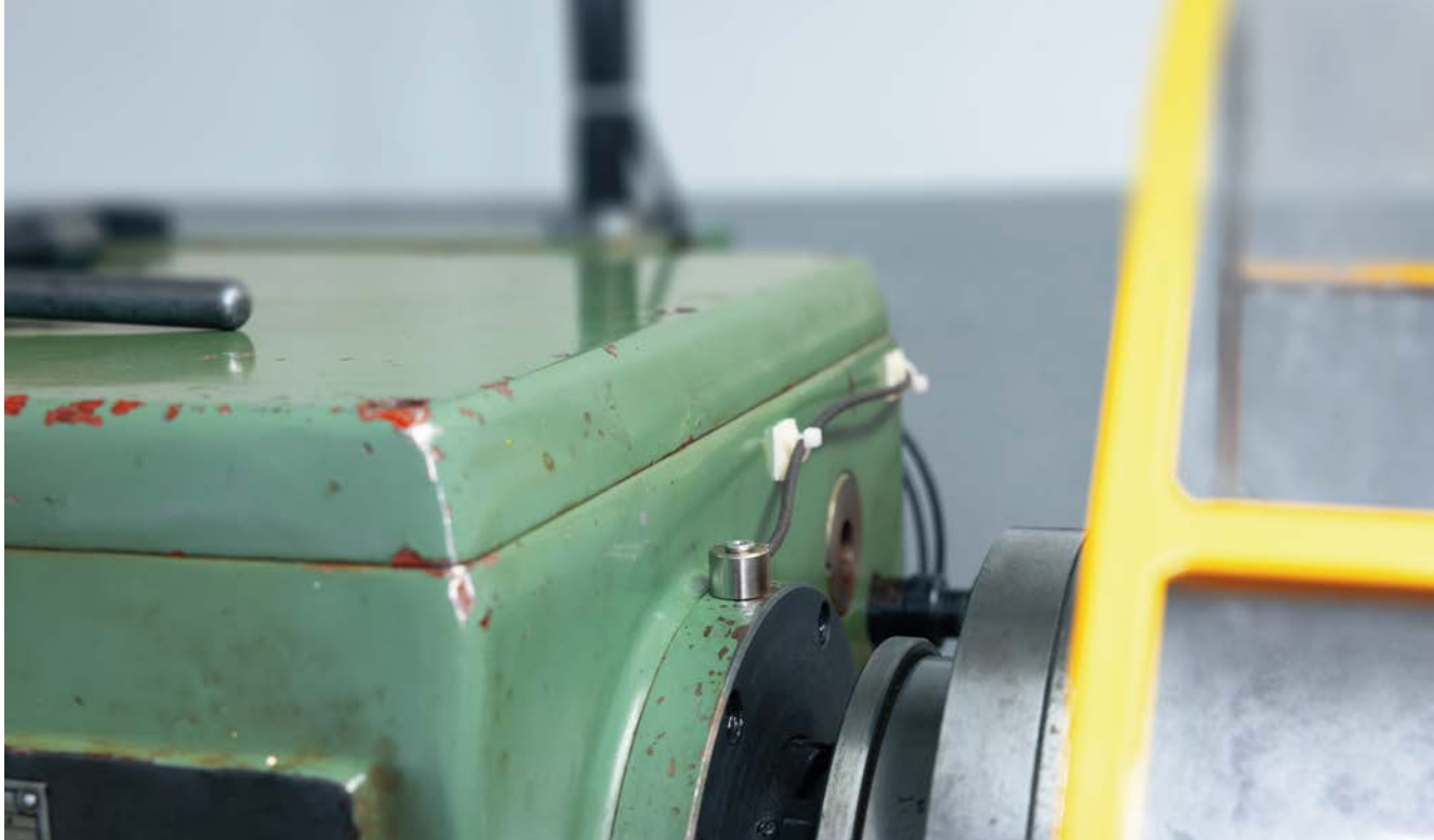
机器的“耳朵”：VSA005振动传感器采集设备传动系统中所有滚动轴承的振动频谱。
