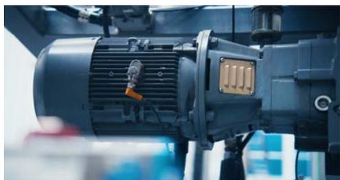
港口智能化改造使得作业流程更透明，并为实现更高的生产力和更好的物流规划铺平了道路，它还缩短了船舶的等待和周转时间。为此，港口运营商要对机械功能进行持续监测，及早发现可能的损坏，提高正常运行时间并避免意外停机。除了各种传感器外，还需要一个分析起重机电机和减速箱振动状态的系统，他们通过ifm的振动检测和状态监测系统找到了完美的解决方案。
