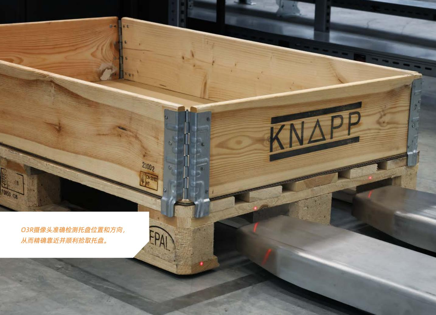
O3R摄像头准确检测托盘位置和方向，从而精确靠近并顺利拾取托盘。
