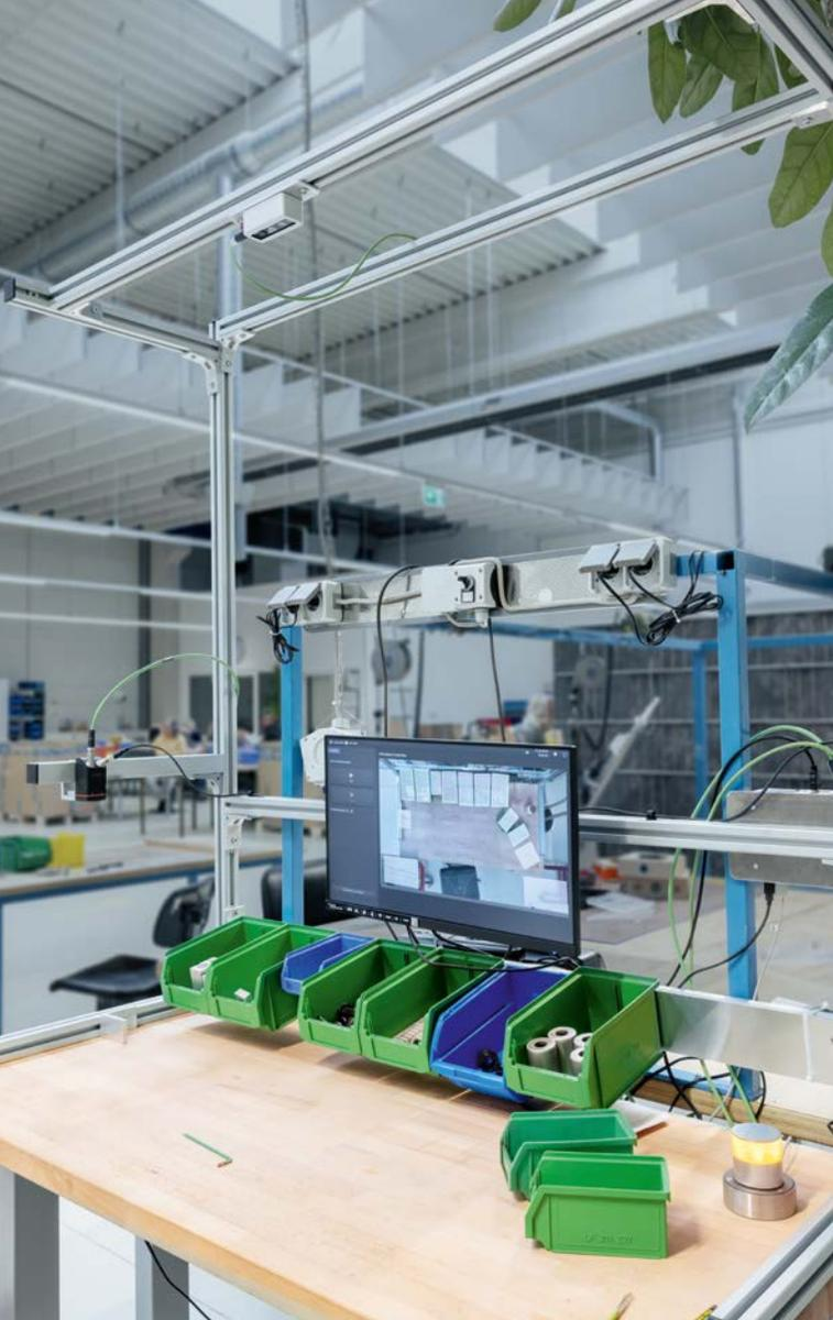
ifm mate是一个完整的解决方案，其中包括摄像头（工作台上）、可通过触摸屏轻松扩展软件和PC、信号灯（右下方）和O2D5视觉传感器（最左侧，安装在横梁上）。
