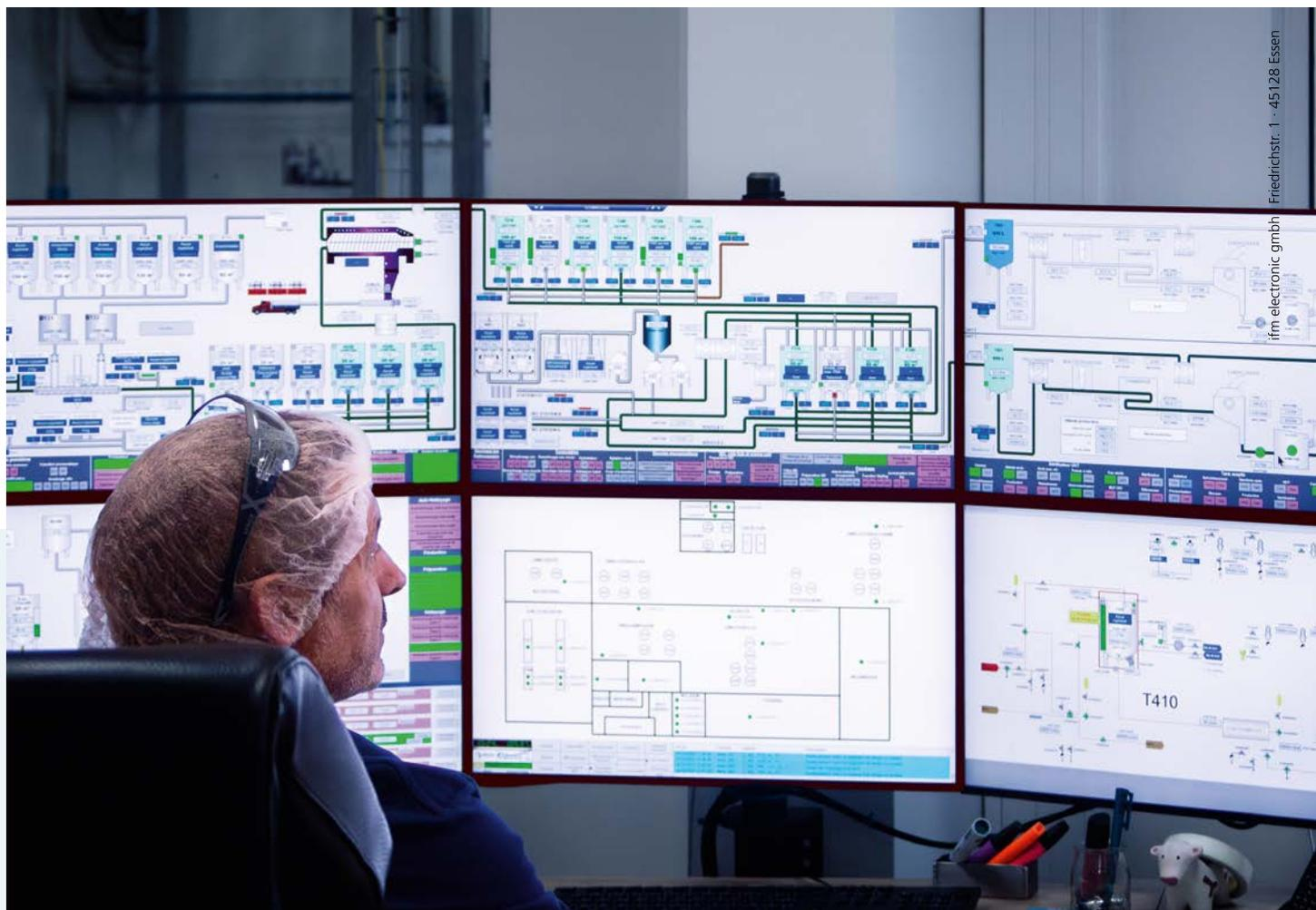
集中过程监测：利用AS-i和IO-Link数字化通信技术，可以对整个过程进行集中监测。
