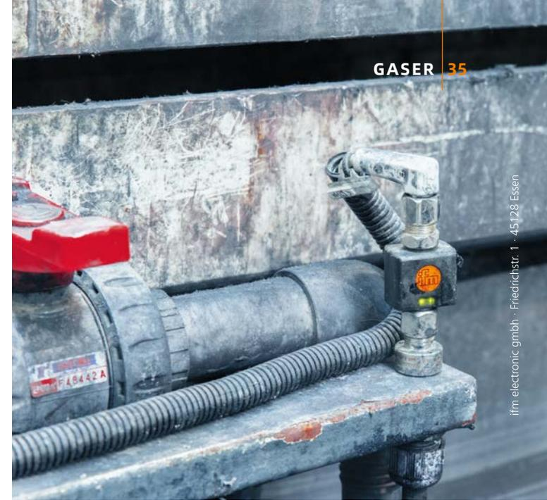
温度探头、估算单元和电缆可承受阳极氧化工艺的恶劣环境条件。
