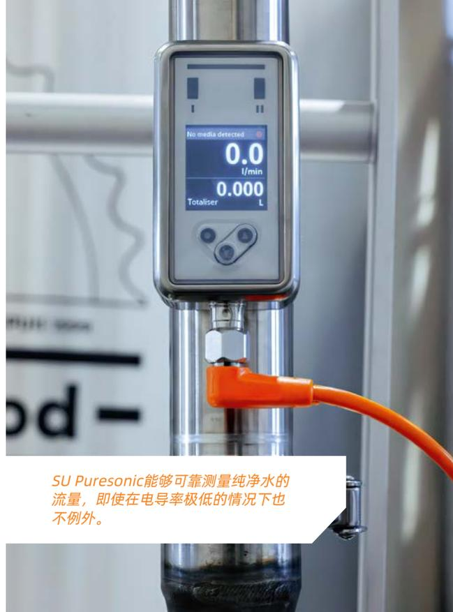
SU Puresonic能够可靠测量纯净水的流量，即使在电导率极低的情况下也不例外。
