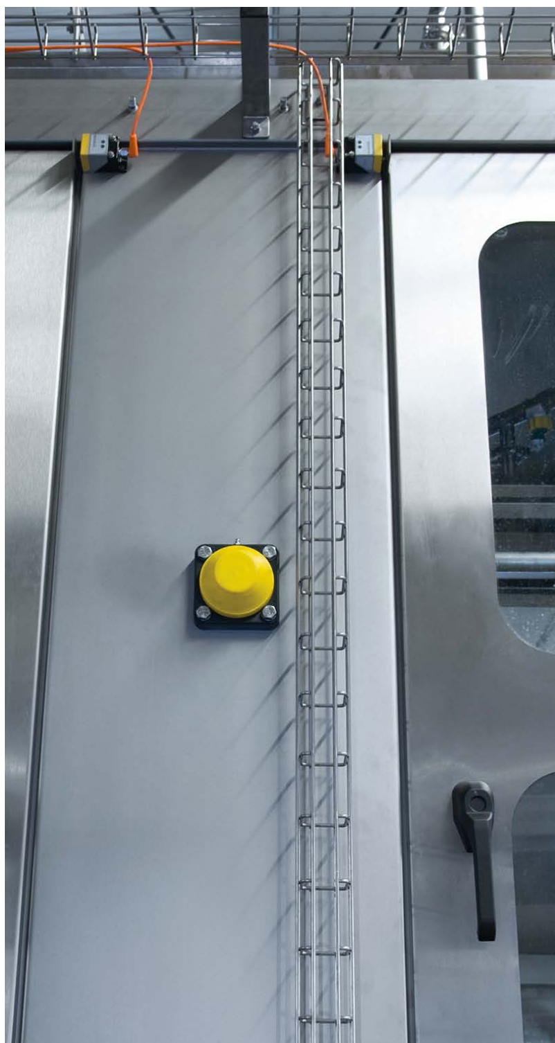
系统的门由防故障电感式接近开关监测。
