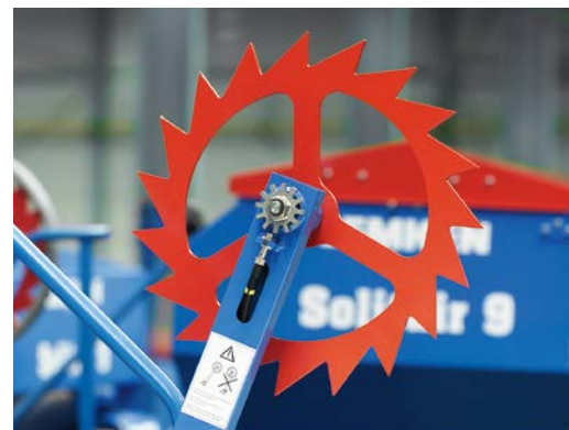
使用电感式传感器的籽种轴监测
