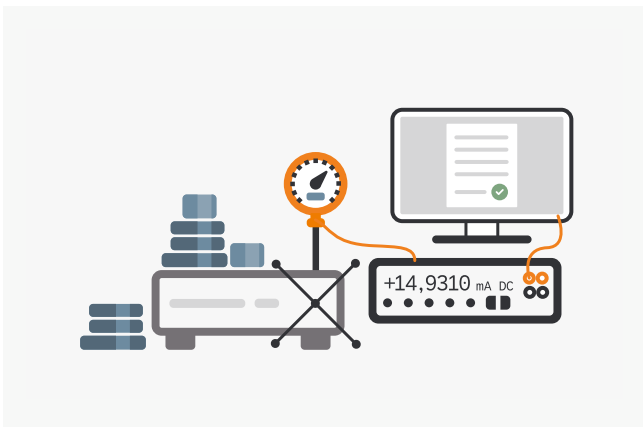
使用压力补偿器进行压力表校准
