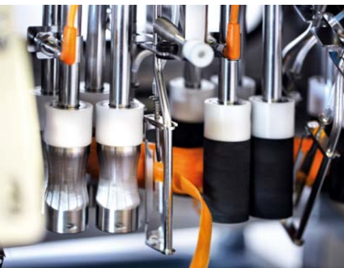
胡萝卜削皮机中的M8系列电感式传感器
