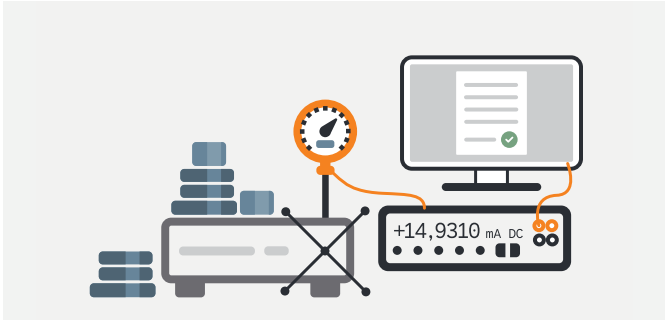
使用压力补偿器进行压力表校准
