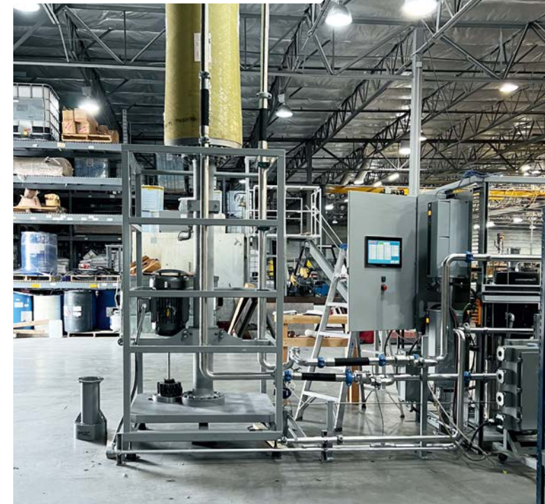
整个系统的核心：过滤系统以及用于在滤膜上产生振动的20 hp电机。
