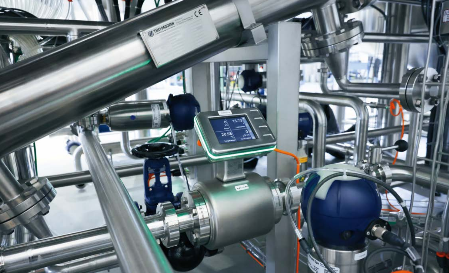
SM Foodmag可以在一个测量点同步检测流量、电导率与温度。
