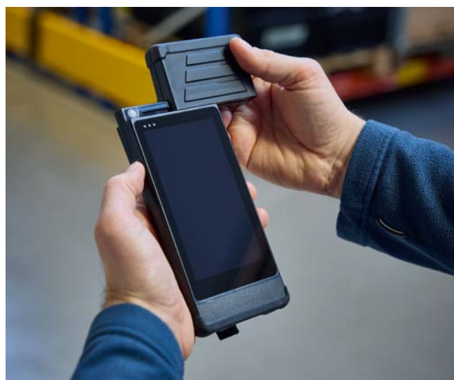
手持设备的各种天线模块可轻松更换。
