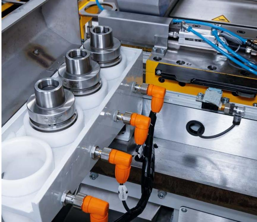
电感式接近开关检测铣头是否存在（左），光电保护装置确保工件在焊接前的精确定位，绝对式多圈编码器则用于长度的精确测量（下）：所有这些任务，Kettec都依赖ifm的传感器技术。
