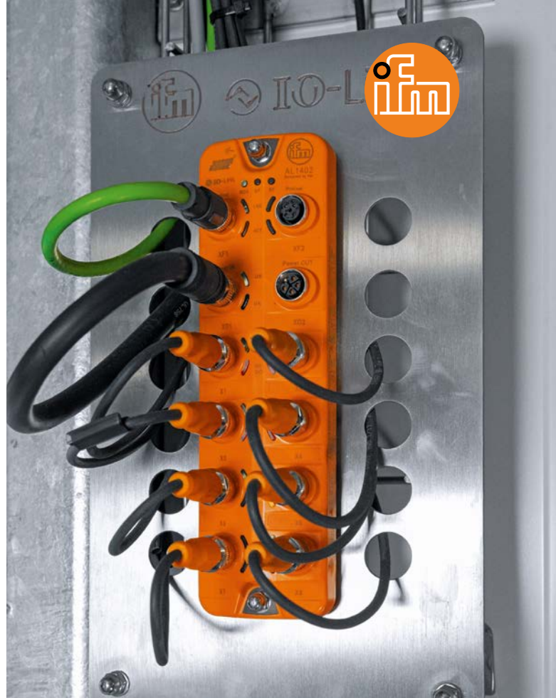
简单的螺纹连接替代繁杂的接线：所有传感器都连接至IO-Link主站，该主站通过Profinet将信号发送至装置控制器。
