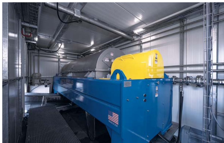
卧螺离心机可以3000倍重力加速度的离心力分离水和干物质，是分离装置的核心部件。
