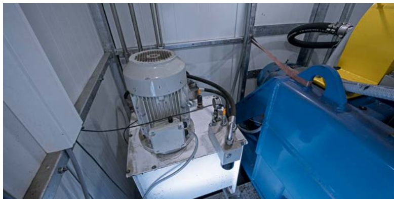
离心机内用于螺旋输送器的电驱动液压装置。
