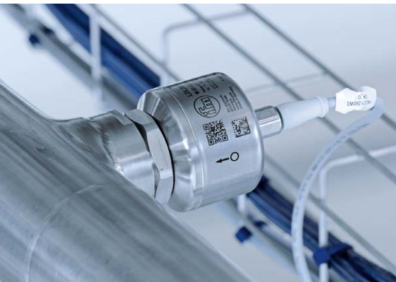
LDL200型电导率传感器能可靠识别生产线中含有的是清水还是CIP过程中的清洁剂。同时，它还能测量温度，并通过IO-Link将2个测量值传输至控制系统。
