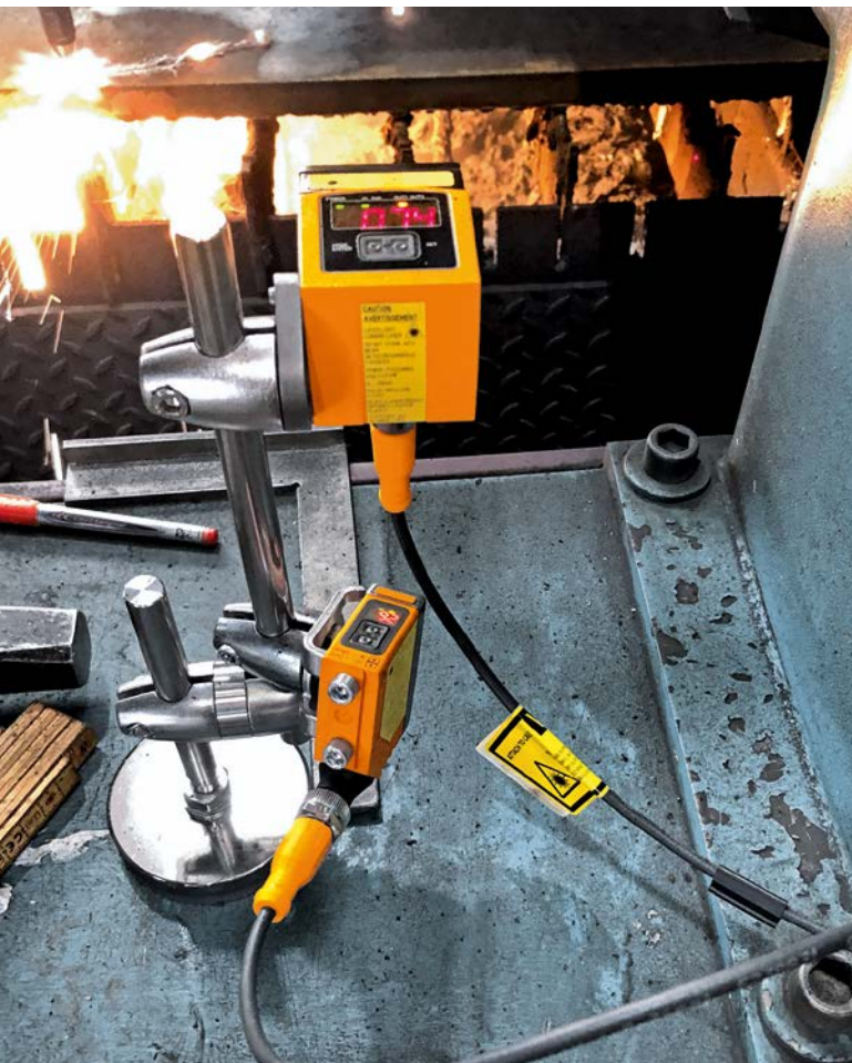
测量利用率：ifm传感器检测机器是正在运行还是处于等待状态。
