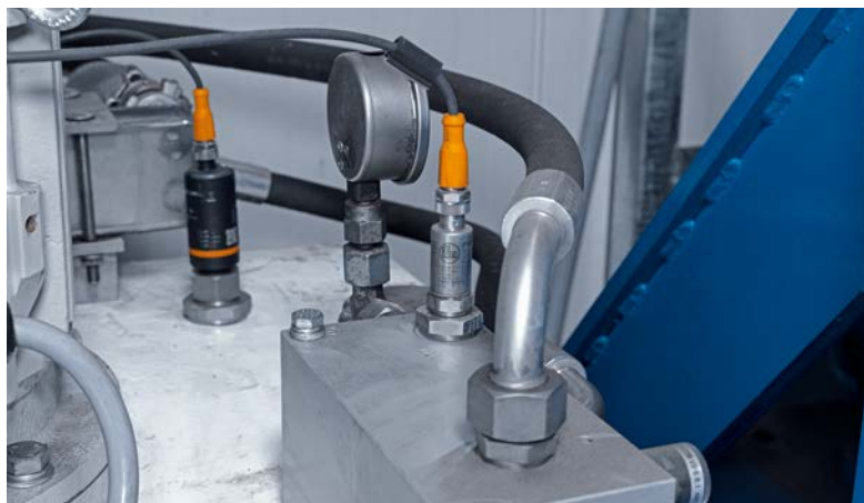
液压装置的压力、油位和温度监测。
