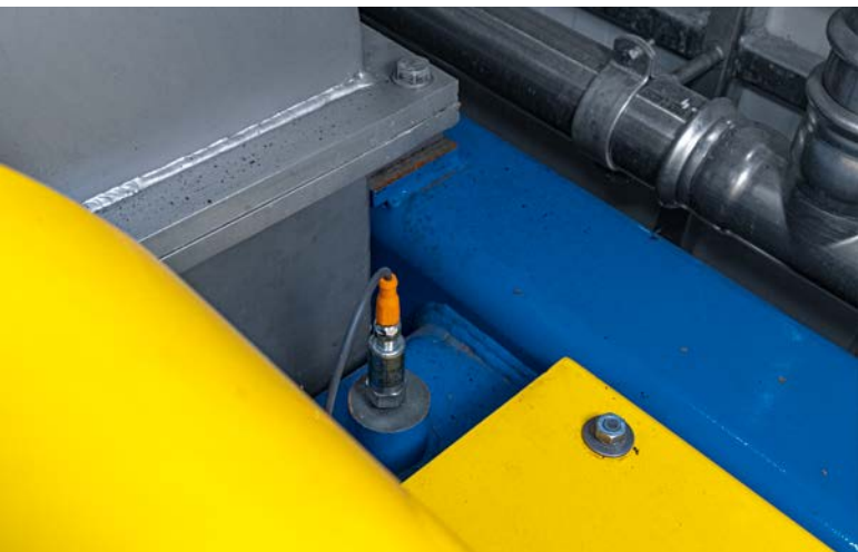
振动传感器确保不会发生危险的振动。
