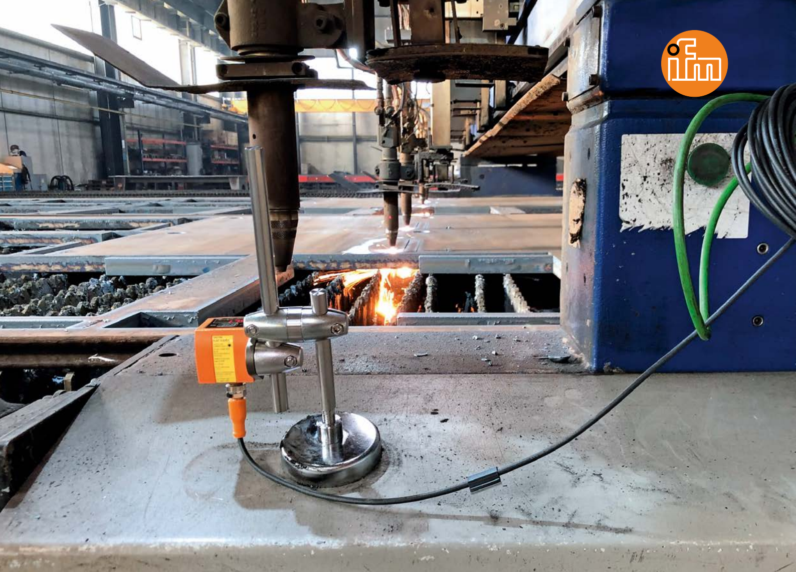
O1D108测距传感器利用光飞行时间测量原理检测切割头是在运行还是等待位置。
