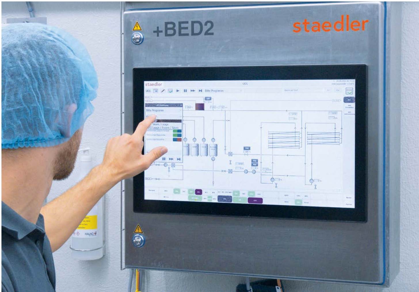
staedler automation AG公司已经实施奶酪厂的过程控制。所有过程值都可在控制系统上查看。
