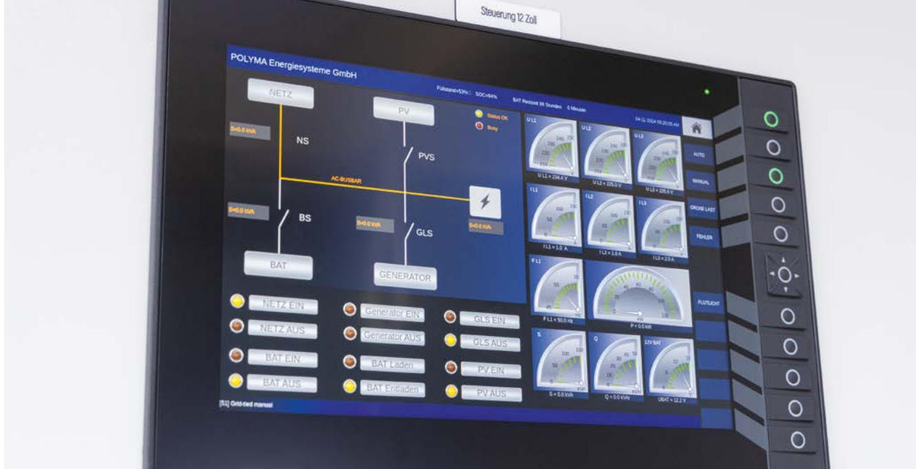
ifm CR1204中央触摸屏用于显示所有操作参数并设置各种功能。
