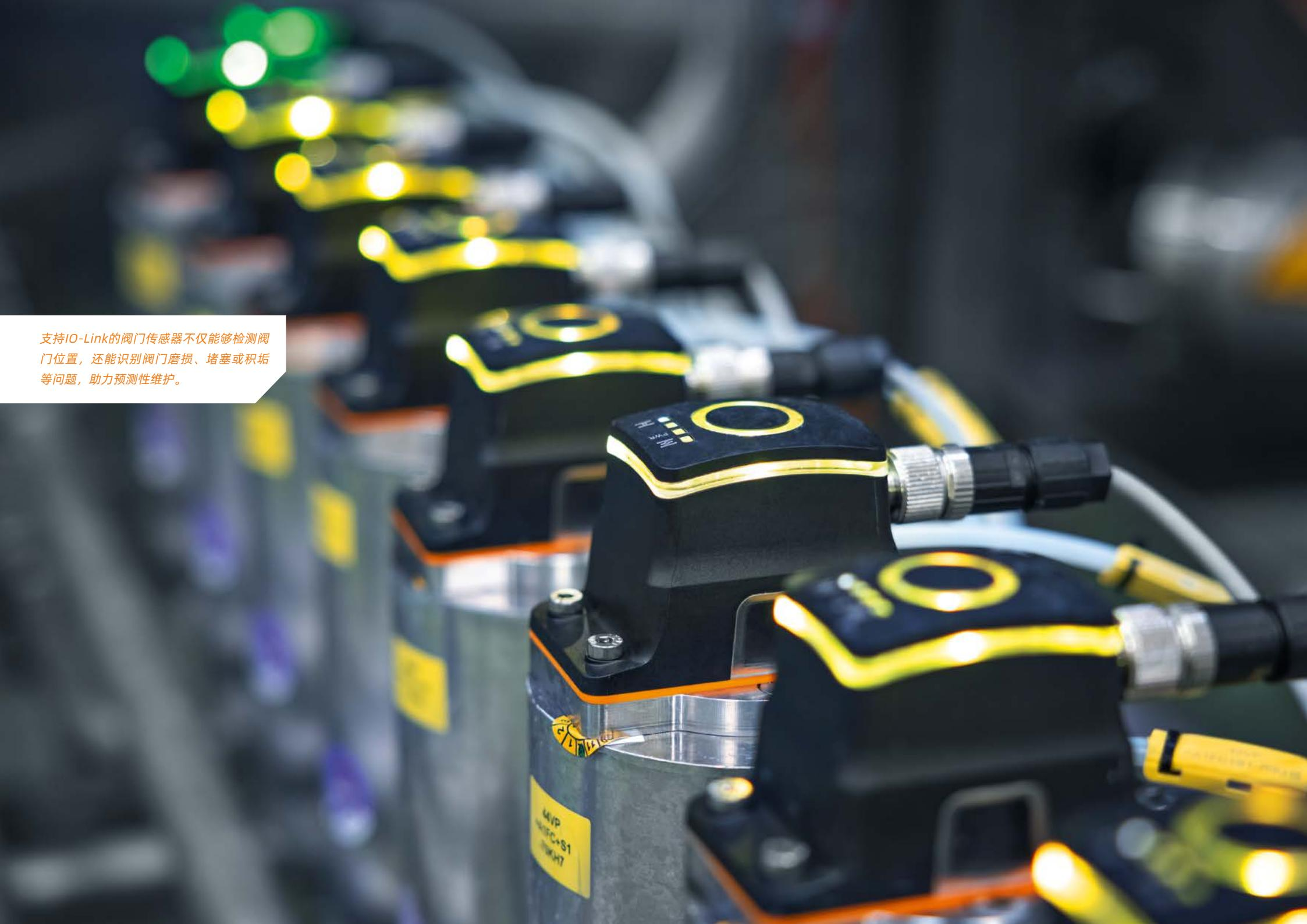
支持IO-Link的阀门传感器不仅能够检测阀门位置，还能识别阀门磨损、堵塞或积垢等问题，助力预测性维护。
