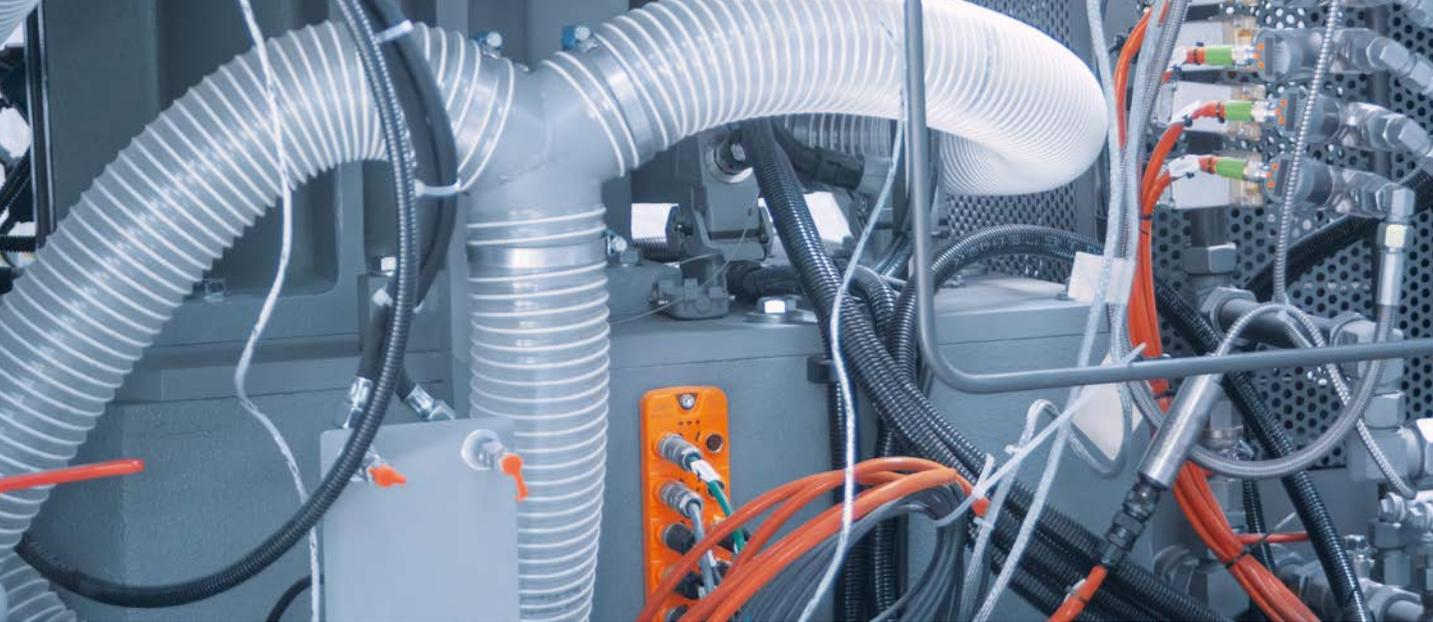
通过IO-Link主站，分布式地收集再生设备的传感器数据并打包传送至控制系统。
