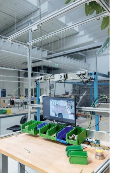
ifm mate是一个完整的解决方案,其中包括摄像头(工作台上方)、可通过触摸屏轻松扩展软件和PC、信号灯(右下方)和O2D5视觉传感器(最左侧,安装在横梁上)。
