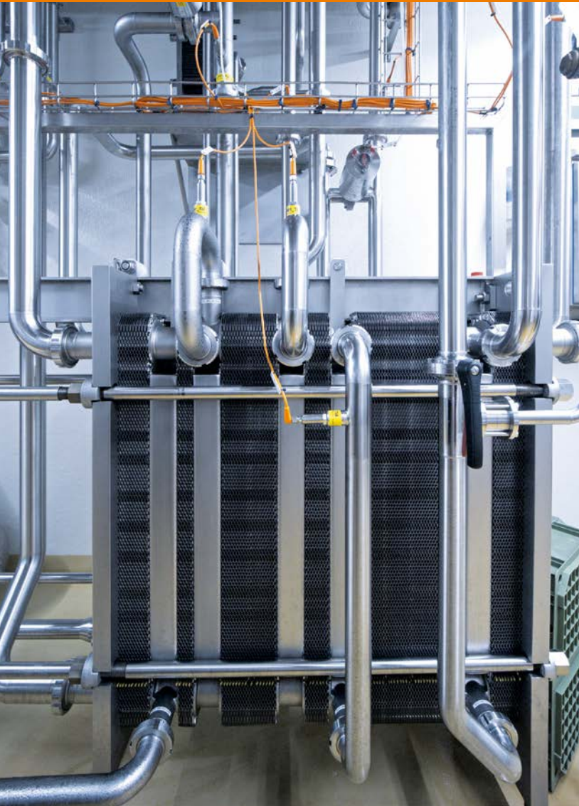
工厂的核心：用于对原奶进行准确温度控制的板式热交换器。
