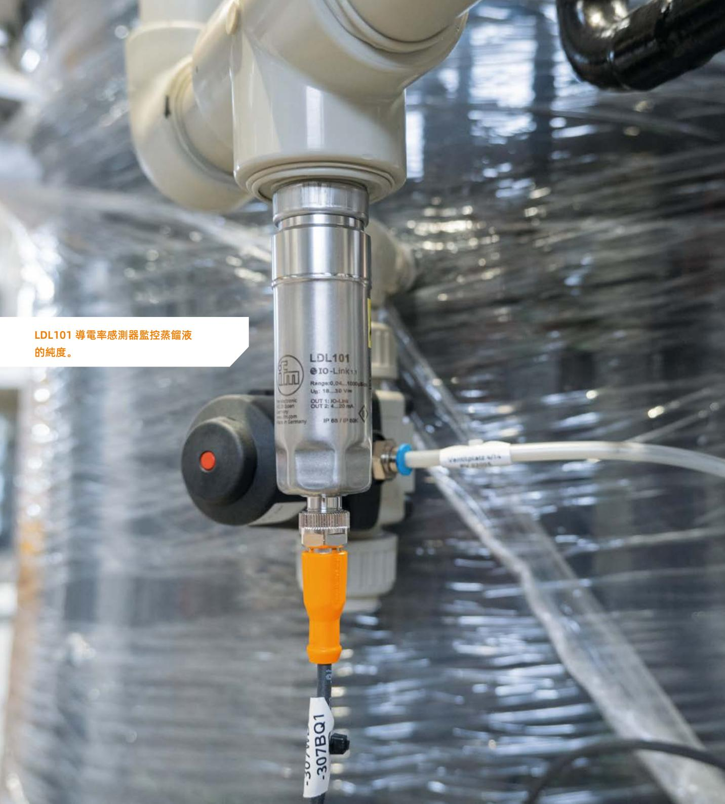
**LDL101 導電率感測器監控蒸餾液的純度。**
