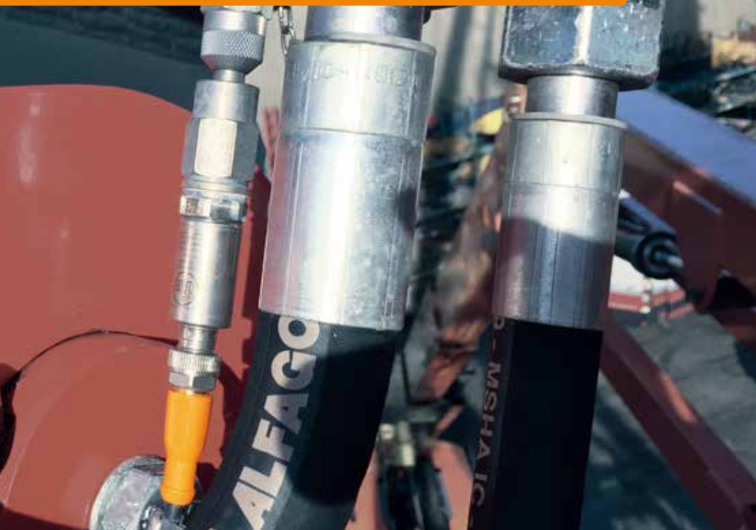
PT / PU型 压力变送器 适用于移动应用。
