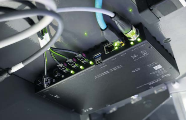
视频处理单元是O3R系统的核心组件，最多可连接6个摄像头。
