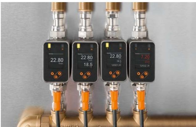
为了单独监控各冷却管路，同时使用多个流量计。凭借纤薄的设计，可以实现理想的安装位置和实用的连接器位置，而无需复杂的接线和移动传感器。这使其可用于内径50 mm的标准布水管。
