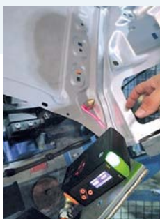
PMD轮廓传感器检测小金属板是否定位准确。
