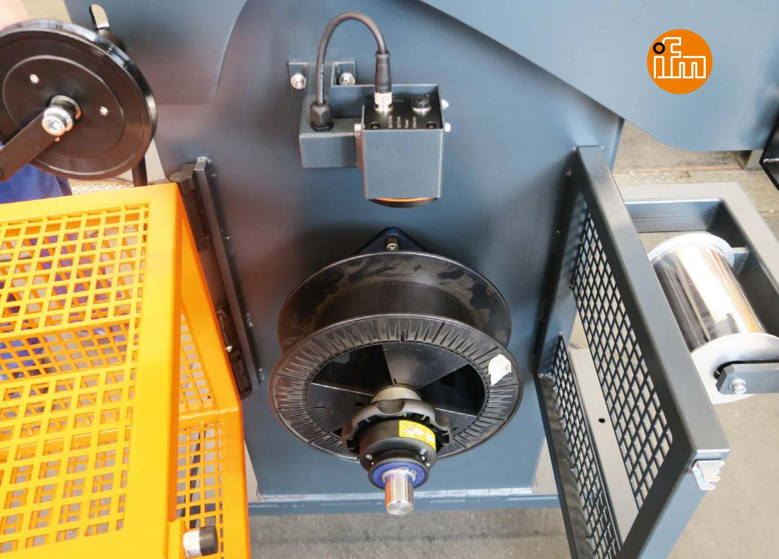
空焊丝轴反射的光远比焊丝要少。
