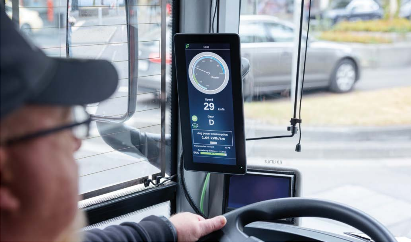
驾驶舱内，坚固的CR1203图形显示器为驾驶员呈现电动系统的所有关键参数。
