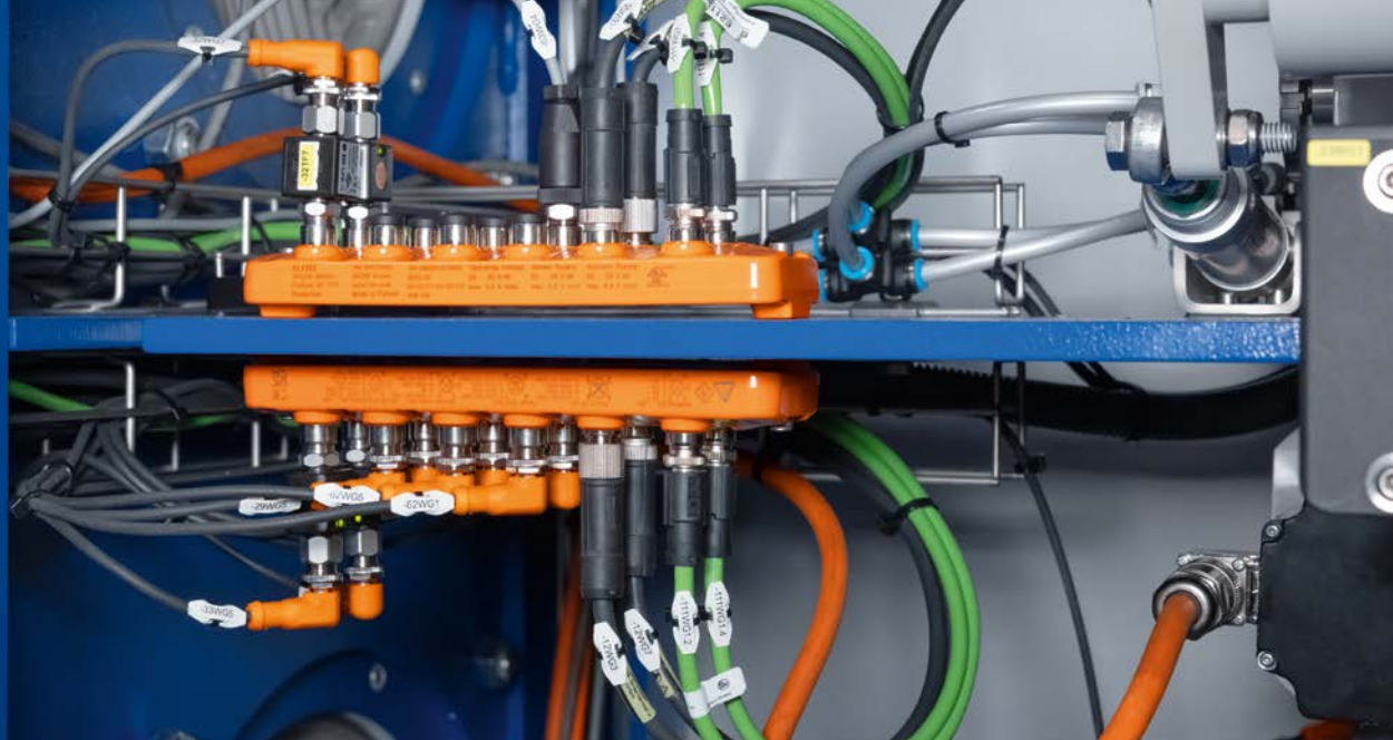
所有传感器的信号由 IO-Link 主站进行整合， 并通过 PROFINET 传输至机器控制器。
