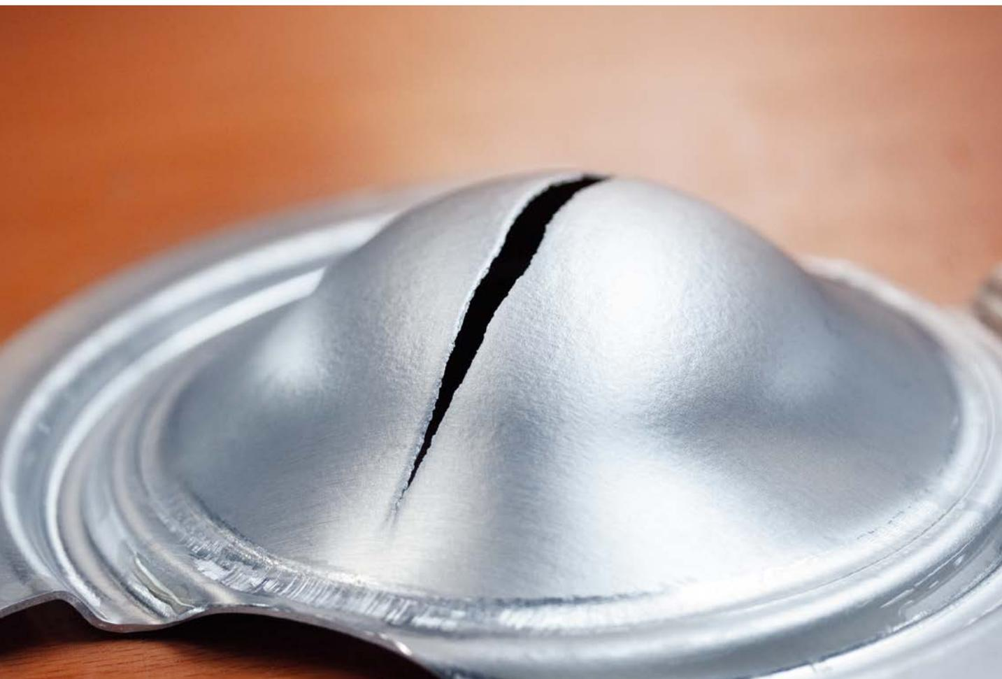
试样显示了Nakajima试验中典型的裂纹形成。通过对材料进行定向过载，可以提供材料是否可成型为汽车零件等信息。
