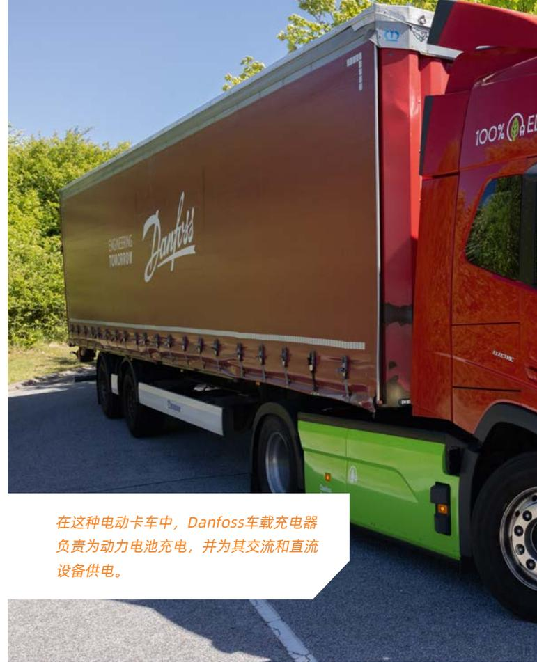
在这种电动卡车中，Danfoss车载充电器负责为动力电池充电，并为其交流和直流设备供电。
